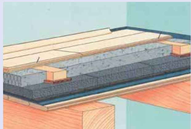
Holzfußboden über sichtbarer Holzbalkendecke
